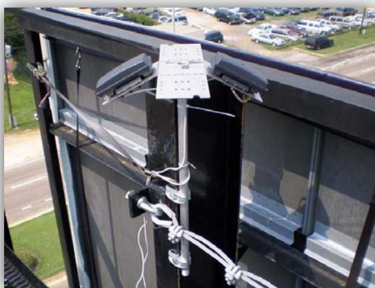
Senzory jasú pre prispôbenie svietivosti obrazovky okolitým podmienkam
